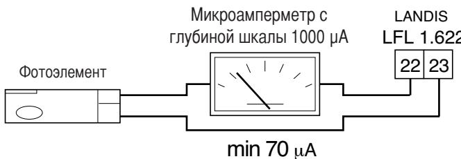
Ток ионизации проверяется с помощью микроамперметра с глубиной шкалы 1000  $\mu\text{A}$  (постоянного тока), который последовательно подключается к фотоэлементу. Как правило, сила тока должна быть не ниже 70  $\mu\text{A}$ .
