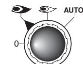
0 = аппаратура управления заблокирована для работы в среднем диапазоне мощности
