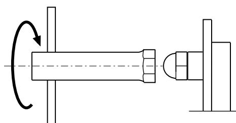
Для демонтажа форсунки пользуйтесь исключительно имеющимся в комплекте ключом. Обратите внимание на то, что бы не повредить электроды. Установите новую форсунку, при этом работу следует выполнить с максимальной осторожностью. Примечание: после замены форсунки, обязательно проверьте положение электродов (см. рис.) Неправильное положение электродов может затруднить розжиг горелки.
